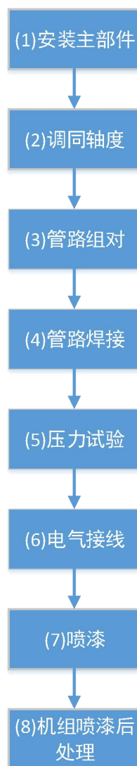
图 1.5 机组装配生产工艺流程图
