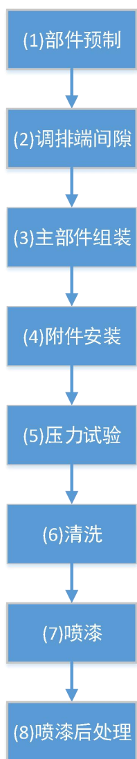
图 1.3 压缩机装配工艺流程图
