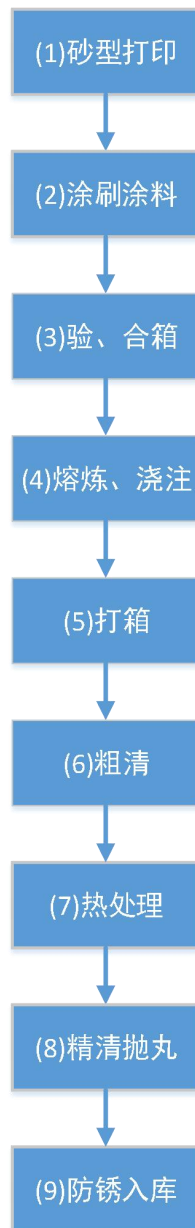
图 1.1 壳体铸造生产工艺流程图
