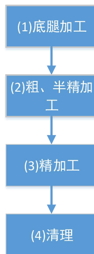
图 1.2 壳体加工生产流程图
