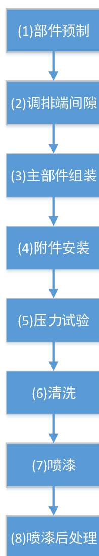
图 1.3 压缩机装配工艺流程图
